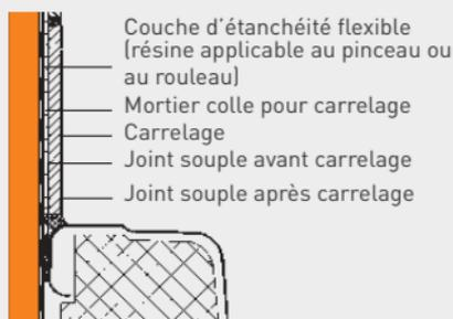
Figure 26 : Raccord horizontal d'une cloison simple peau avec un appareil receveur (douche, baignoire).
