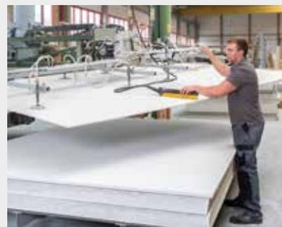
Manipulation des plaques **fermacell** avec un appareil de levage à ventouses
