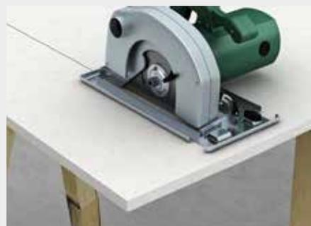
Scie circulaire portable guidée par un rail
